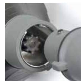
Attacco rapido utensili Shaft release system
