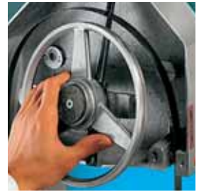
Sistema brevettato estrazione e supporto puleggia Patented pulley support removing system
