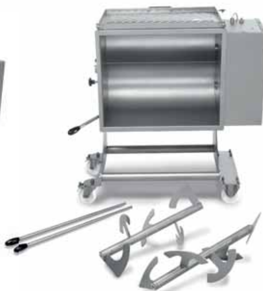
Pale facilmente rimovibili Removable mixing arms
