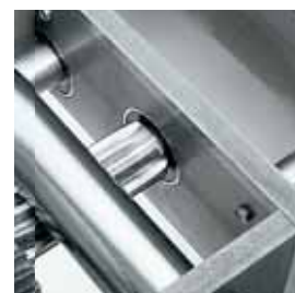
Protezione cilindro oleodinamico e valvole sfiato aria tampone Hydraulic cylinder protection and pad exhaust valves
